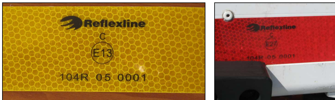
Obr. č. 4.: Reflexné materiály s falošnou homologizačnou značkou podľa predpisu EHK č. 104.
