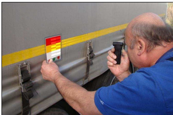
Obr. č. 3.: Kontrola spätnej odrazivosti reflexného označenia podľa predpisu EHK č. 104 pomocou optického komparátora a vzorkovníka.
