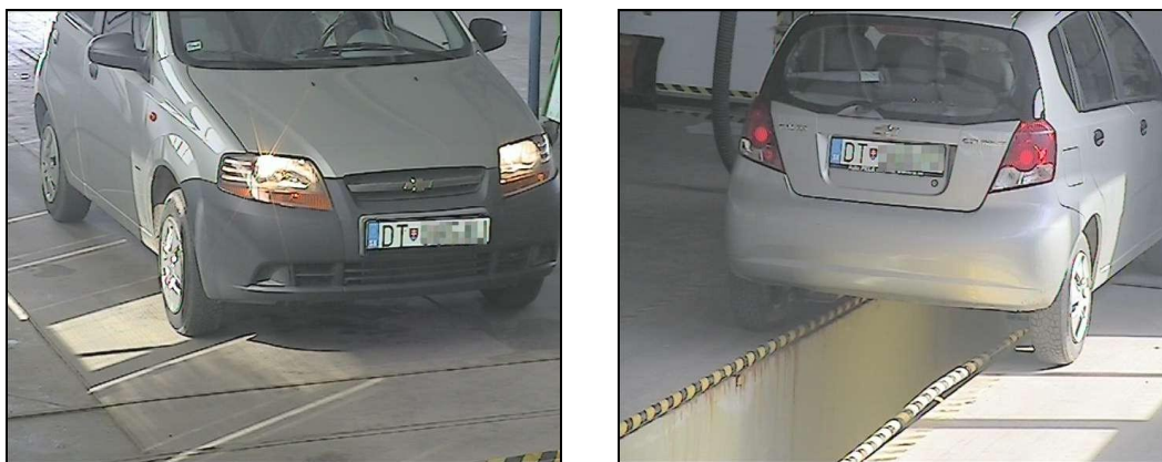
Obr. č. 2.: Snímky z kamier na vstupe a výstupe z kontrolnej linky počas skúšobnej prevádzky kamerového systému na STK. Evidenčné číslo vozidla je zámerne čiastočne znečitateľné kvôli ochrane identity pri zverejnení záberov.
