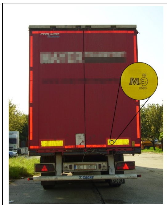
Obr. č. 20. V detaile vidno správnu sériu zmien predpisu EHK č. 70, takéto zadné označovacie tabuľky môžu byť integrované do zadného označenia obrysov.
