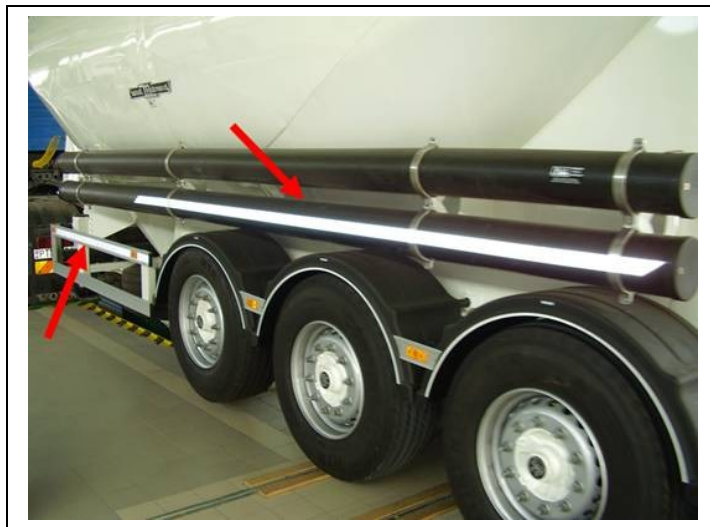
Obr. č. 7. Líniové bočné označenie na cisternovom návесе rozdelené na viacero častí.
