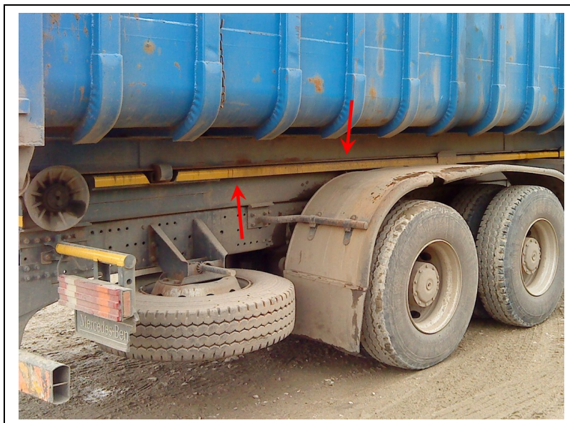
Obr. č. 11. Líniové bočné označenie na nosiči kontajnerov na ráme podvozku. Bližšie k bočnému okraju vozidla ho nemožno v danom úseku umiestniť. (foto PAL-KOV Dubnica nad Váhom)
