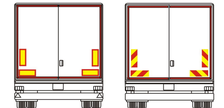
Obr. č. 17. Kombinácia označenia obrysov a označovacích tabuliek pre dlhé a ťažké vozidlá (vľavo prípojné vozidlo, vpravo motorové vozidlo).
