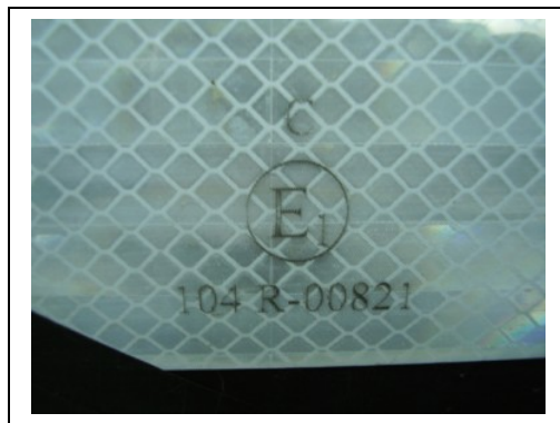
Obr. č. 1: Homologizačná značka materiálu na vyznačenie obrysov vozidla.
