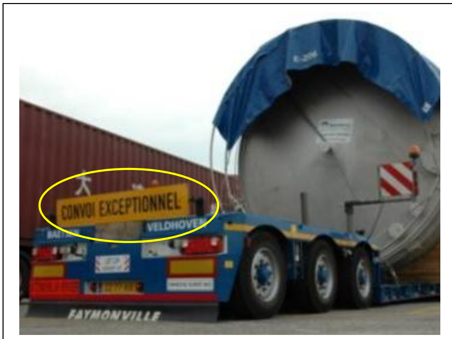
Obr. 19.: Umiestnenie špeciálneho označenia vozidla vykonávajúceho nadmernú a nadrozmernú prepravu.
