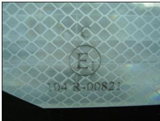
Obr. 4.: Schvaľovacia značka podľa predpisu EHK č. 104 na reflexnom páse bielej farby. Znak „C“ v hornej časti určuje, že ide o pás na vyznačenie obrysov vozidla. Materiál na nepovinné plošné nápisy a grafiku má označenie „D“ (pre použitie na obmedzených plochách) alebo „E“ (pre použitie na veľkých plochách).
