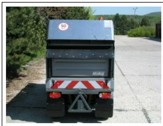
Obr. 11.: Špeciálne označenie vozidla umiestnené na vozidle vykonávajúcim prácu za jazdy – zametacie vozidlo; obdobné označenie musí byť na vozidle umiestnené aj vpredu.
