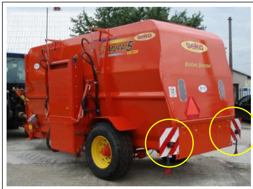
Obr. 15.: Špeciálne označenie vozidla umiestnené na ťahanom vymeniteľnom stroji za traktor vzadu; uvedené označenie musí byť na vozidle umiestnené aj vpredu po oboch stranách.
