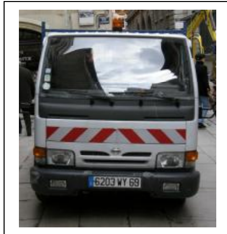
Obr. 12.: Špeciálne označenie vozidla umiestnené na vozidle vykonávajúcom prácu za jazdy – vozidlo správcu pozemnej komunikácie; obdobné označenie musí byť na vozidle umiestnené aj vzadu.
