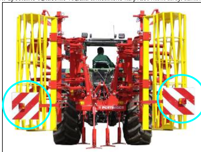
Obr. 14.: Špeciálne označenie vozidla na pracovnom stroji nesenom umiestnenom na traktore.
