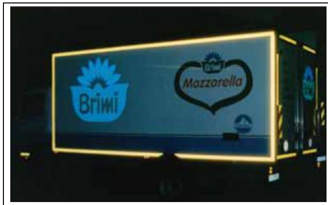
Obr. 8.: Pohľad na vozidlo so špeciálnym označením na zvýšenie viditeľnosti a rozoznatelnosti za zníženej viditeľnosti.
