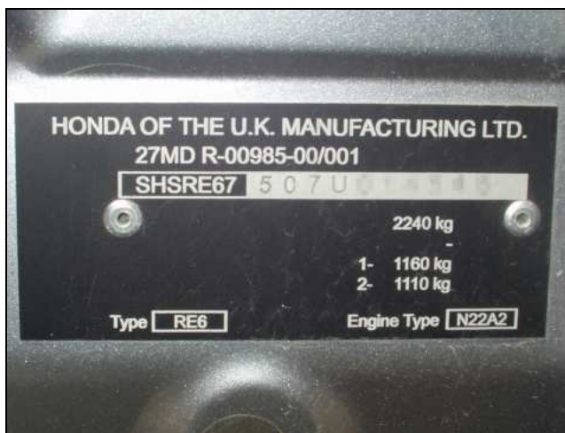
Obr. 2.: Výrobný štítok Hondy CR-V kategórie N 1 so slovenským národným typovým schválením. „27MD R-00985-00/001“ je číslo schválenia.
