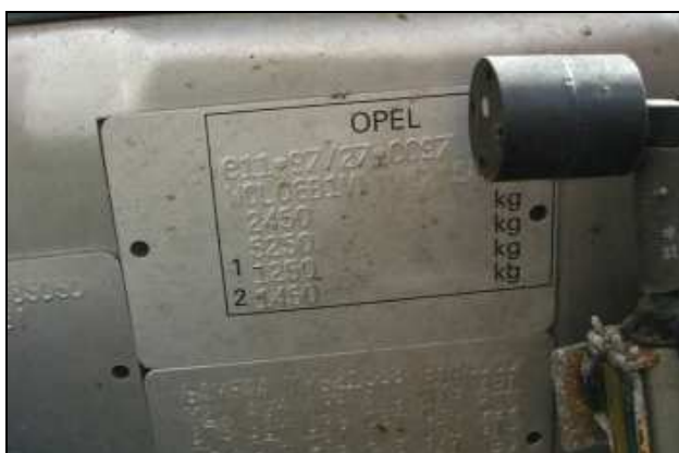
Obr. 3.: Výrobný štítok Opla Frontera kategórie N 1 síce obsahuje číslo typového schválenia ES (e11*97/27*0097), ale podľa staršej smernice 97/27/ES. Ide o výrobný štítok pôvodného osobného automobilu, ktorý na vozidle ostal i po prestavbe. Typové schválenie ES je preto v tomto prípade neaktuálne.
