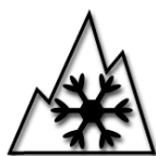
Obr. 4. Príklad označenia pneumatiky pre jazdu na snehu horským symbolom. Symbol môže byť tvorený horským štítom so snehovou vločkou alebo snehovou vločkou v horskom štíte s tromi vrcholmi.
