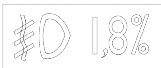
Obr. č. 2.: Príklad označenia základného nastavenia sklonu lúčov predného svetlometu do hmly.
