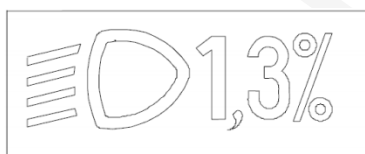
Obr. č. 1.: Príklad označenia základného nastavenia sklonu lúčov stretávacieho svetla.
