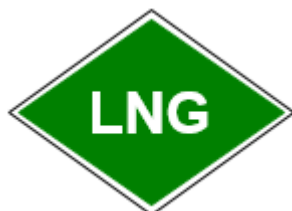
Obr. č. 3c: Príklad označenia vozidla s pohonným systémom na skvapalnený zemný plyn
