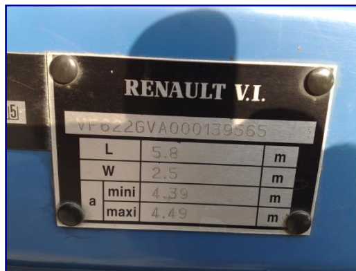
Obr. č. 5. Príklad štítka rozmerov ťahača návesov Renault Magnum.
