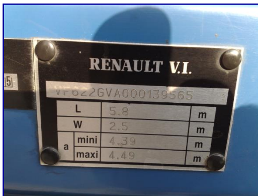
Obr. č. 5. Príklad štítku rozmerov ťahača návesov Renault Magnum.
