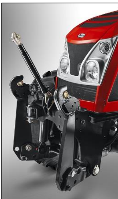
Obr. 6b: Trojbodový záves (TBZ) v prednej časti traktora
