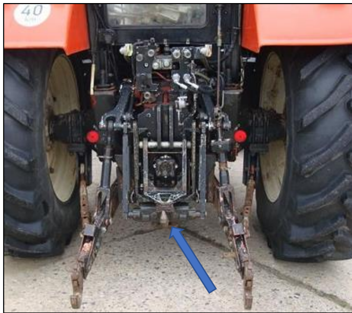
Obr. 6e: Hákové závesné spojenie - „Agrohák“
