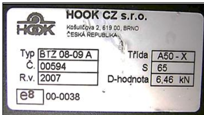
Obr. 17: Príklad štítku spájacieho zariadenia motorového vozidla.
