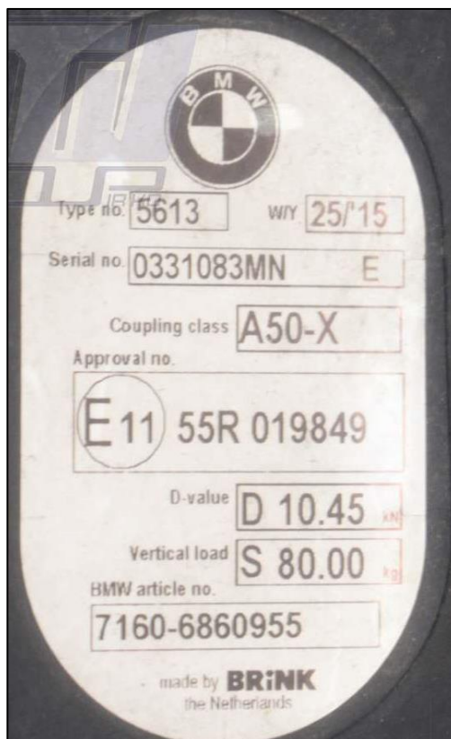
Obr. 13: Štítky spájacích zariadení, na ktorých sú uvedené aj značky vozidiel.
