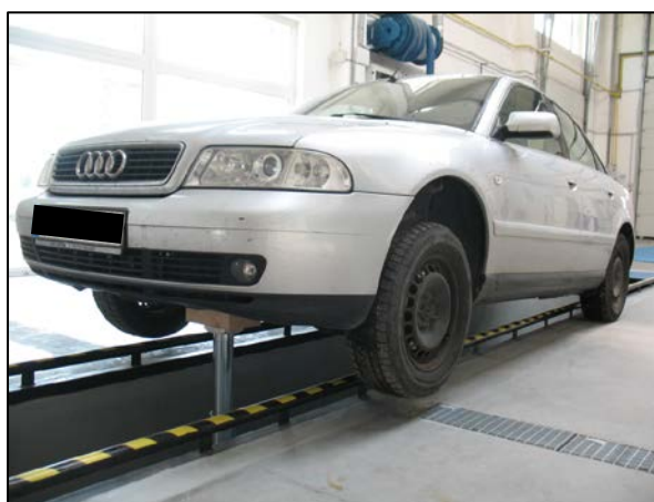
Obr. č. 2. Pridvihnutá riadiaca náprava ako alternatíva k použitiu otočných plošín.
