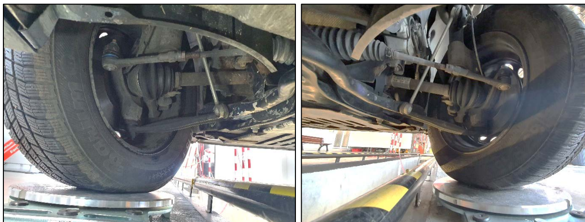
Obr. č. 5 a 6. Vizuálna kontrola funkcie mechanizmu riadenia vozidla nad kontrolnou jamou.
