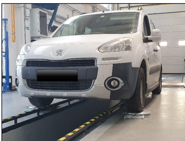
Obr. č. 1. Umiestnenie vozidla nad kontrolnou jamou s kolesami na otočných plošinách.
