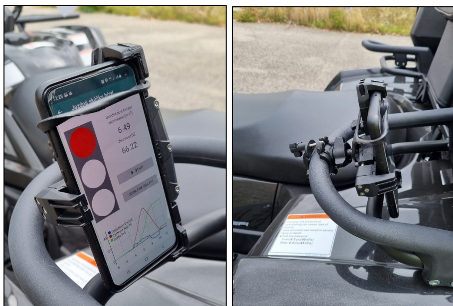
Namerané hodnoty zbrzdenia a detail uchytenia pri umiestnení telefónu na zadný nosič.
