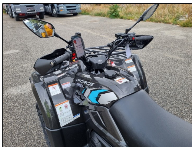
Uchytenie telefónu priamo na riadidlá vozidla.
