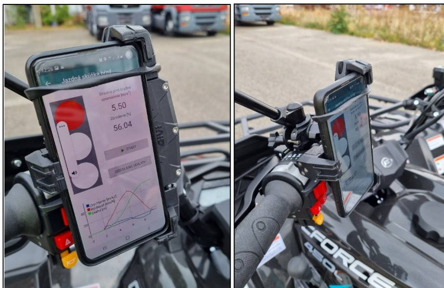
Namerané zbrzdenia a detail uchytenia telefónu na riadidlá vozidla.
