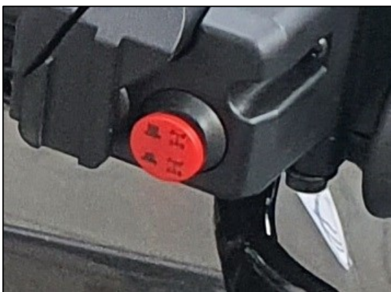
Spínač pre zapnutie pohonu všetkých kolies.
