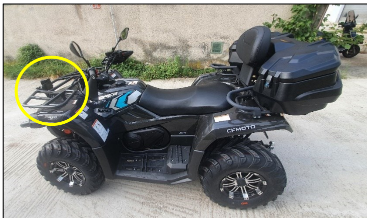
Vozidlo kategórie T s pripevneným meradlom spomalenia (mobilné zariadenie s aplikáciou mSTK) na prednom nosiči.
