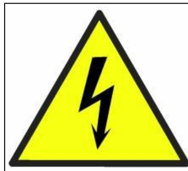
Obr. č. 10: Príklad piktogramu na označenie dobíjateľného zásobníka energie s vysokým napätím vozidiel na elektrický pohon
