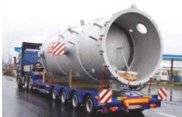
Obr. 9.: Špeciálne označenie širokých vozidiel a vozidiel vykonávajúcich prácu za jazdy.
