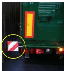
Obr. 9.: Špeciálne označenie širokých vozidiel a vozidiel vykonávajúcich prácu za jazdy.
