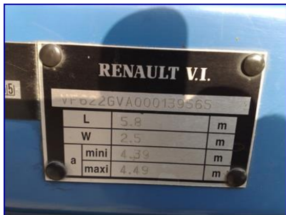
Obr. č. 5. Príklad štítiku rozmerov ťahača návesov Renault Magnum
