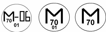
7. Príklad značky typového schválenia ES tachografu (spravidla je uvedená na výrobnom štítku tachografu)
