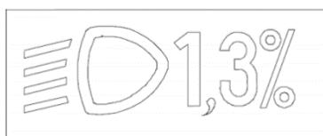
Obr. č. 5.: Príklad označenia základného nastavenia sklonu lúčov stretávacieho svetla.
