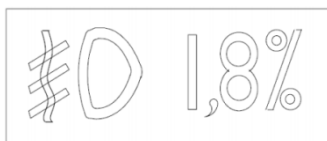
Obr. č. 8.: Príklad označenia základného nastavenia sklonu lúčov predného svetlometu do hmly.
