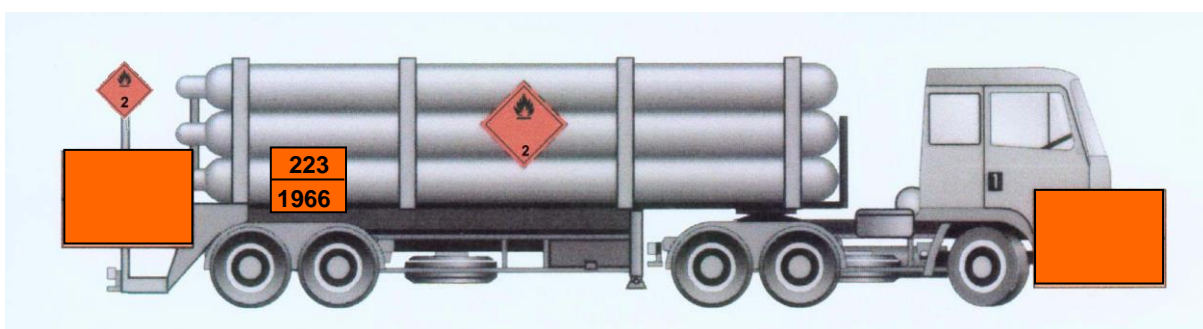
Obrázok č. 4 : Označenie batériového vozidla výstražnými tabuľami a bezpečnostnými značkami (číselné identifikačné tabule sa musia vzťahovať na každú prepravovanú látku, ktorá je prepravovaná v jednotlivých článkoch batériového vozidla)
