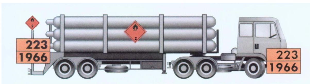
Obrázok č. 3 : Označenie cisternového vozidla s prívesom pri preprave jednej nebezpečnej látky (vo výbave dopravnej jednotky je potrebné mať jednu výstražnú tabuľu navyše pre prípad odpojenia prívesu)
