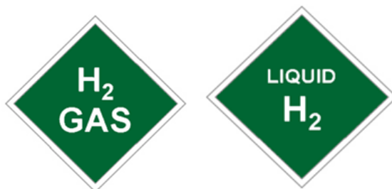
Obr. č. 9: Príklad označenia vozidla s pohonným systémom na stlačený (plynný) vodík a skvapalnený vodík
