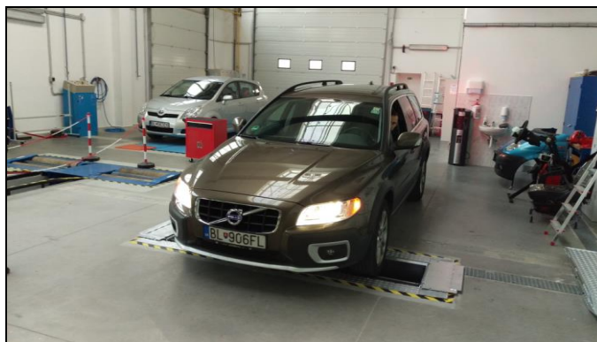
Obr. 3. Nová valcová skúšobňa Roboterm pre vozidlá s pohonom všetkých štyroch kolies v školiacom stredisku.
